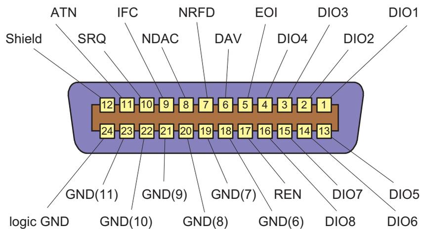
Abbildung 6-17: Pinbelegungen der IEC-Bus-Schnittstelle
