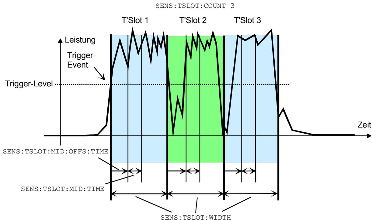
Abbildung 6-10: Timeslot-Parameter
