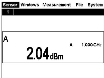
Auf dem Bildschirm ist ein Anzeigefenster mit dem Messergebnis von Messkopf A (in dBm) sichtbar.
