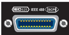
Der IEC-Bus-Anschluss nach IEEE488 dient zur Fernsteuerung des R&S NRP.
