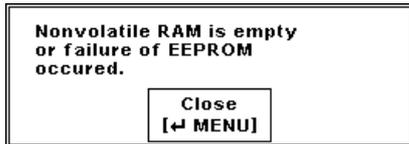
Wenn bei der Überprüfung des nichtflüchtigen Speichers für die Geräteeinstellungen ein Fehler gefunden wird, erscheint zum Abschluss des Bootvorgangs eine Fehlermeldung auf dem Display. Der nichtflüchtige Speicher wird daraufhin komplett neu initialisiert, und das R&S NRP wird in den Pre-set-Zustand versetzt. Durch diesen Vorgang gehen alle gespeicherten Geräteeinstellungen verloren.
