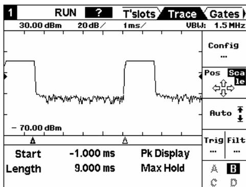
Bild 4-39 Trace-Darstellung im expandierten Fenster mit Bedienelementen.
