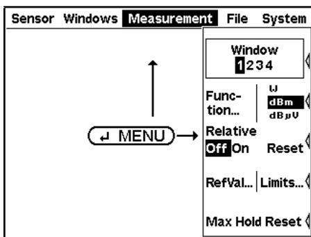
Anders als vom PC her gewohnt, klappt das Menü nicht direkt unter dem Menünamen in der Menüleiste aus, sondern immer am rechten Rand. Dadurch stehen die Menüpunkte direkt neben den Wipptastern, mit denen sie bedient werden.
