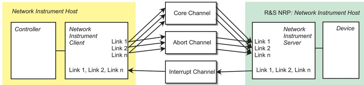
Abbildung 6-20: Diagramm einer VXI11-Verbindung mit mehreren Links
