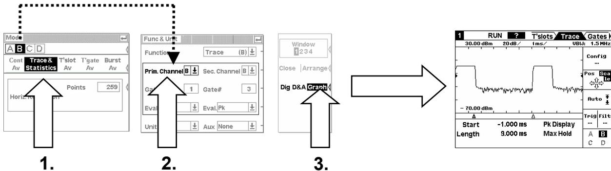
Wichtig ist, dass sich der ausgewählte Messkanal im Modus **Trace & Statistics** befindet und als **Prim. Channel** eingetragen ist.
