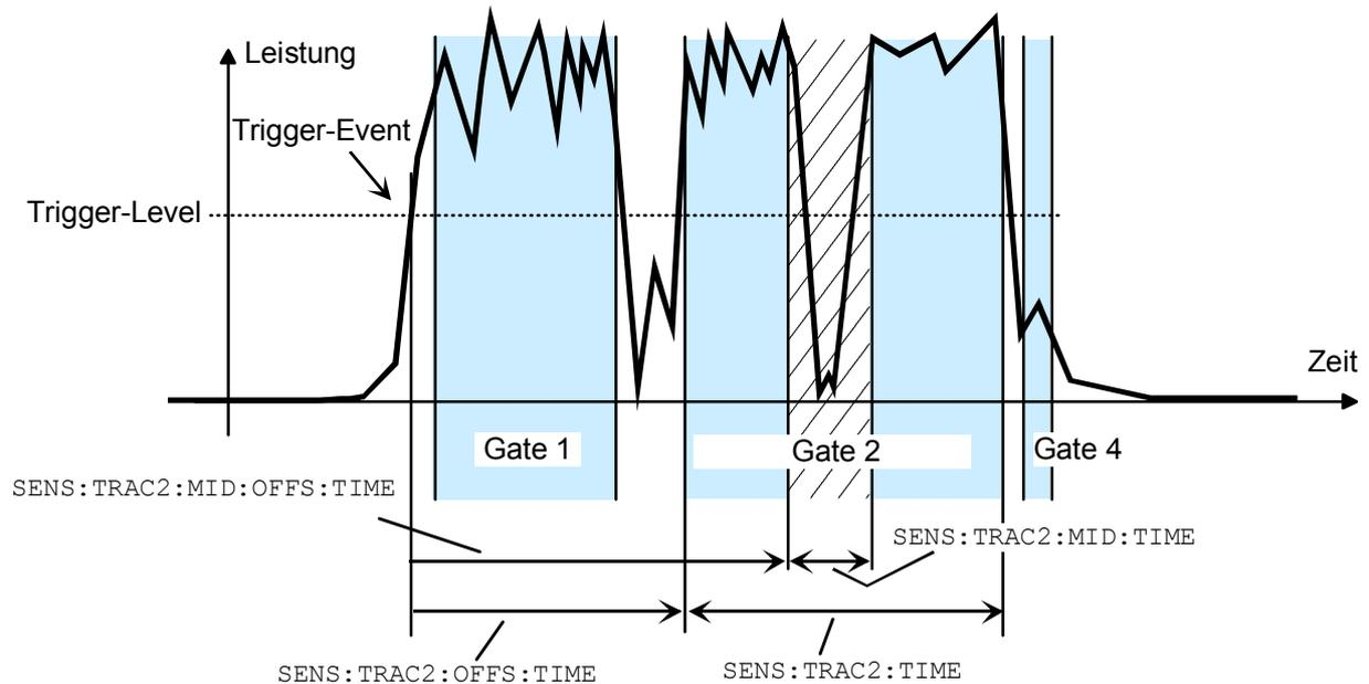
Abbildung 6-8: MID-Parameter im Timegate-Modus
