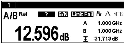
Die Anzeige der Messwerte erfolgt beim R&S NRP in Fenstern. Es können bis zu vier Fenster auf dem Display angezeigt werden. Sie sind mit den Ziffern 1 bis 4 gekennzeichnet. Fenster haben eine Titelleiste, die die (unveränderbare) Nummer und einen (einstellbaren) Namen für das Fenster zeigt.
