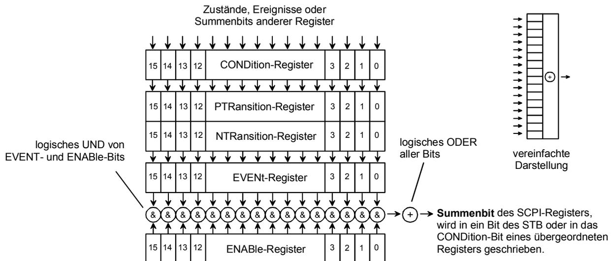
Abbildung 6-12: Standard SCPI-Statusregister
