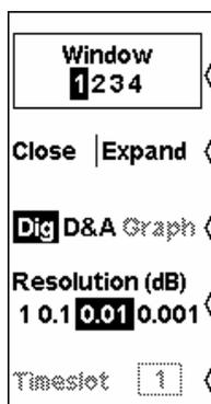
Das **Windows**-Menü dient zur Konfiguration der Fenster und der Messwertdarstellung in den Fenstern.
