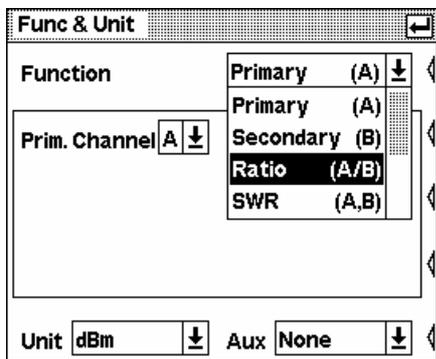
Hier lässt sich die Funktion auswählen, die zur Berechnung des Messergebnisses im aktiven Fenster benutzt wird. So bildet z. B. **Ratio (A/B)** den Quotienten aus den Leistungsmesswerten in Kanal A und B.
