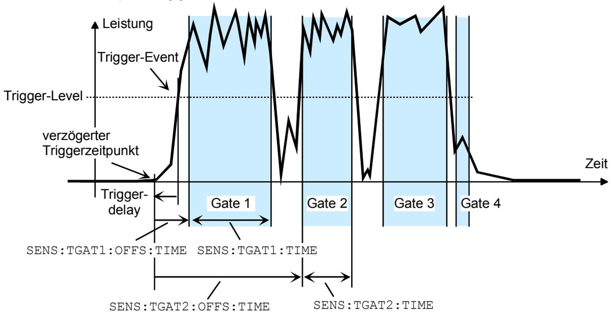
Abbildung 6-9: Timingparameter für den Timegate-Modus.
