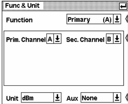
Im Dialog Function & Unit lassen sich Messfunktion, Einheit, verwendete Sensoren und der Sekundärwert auswählen.
