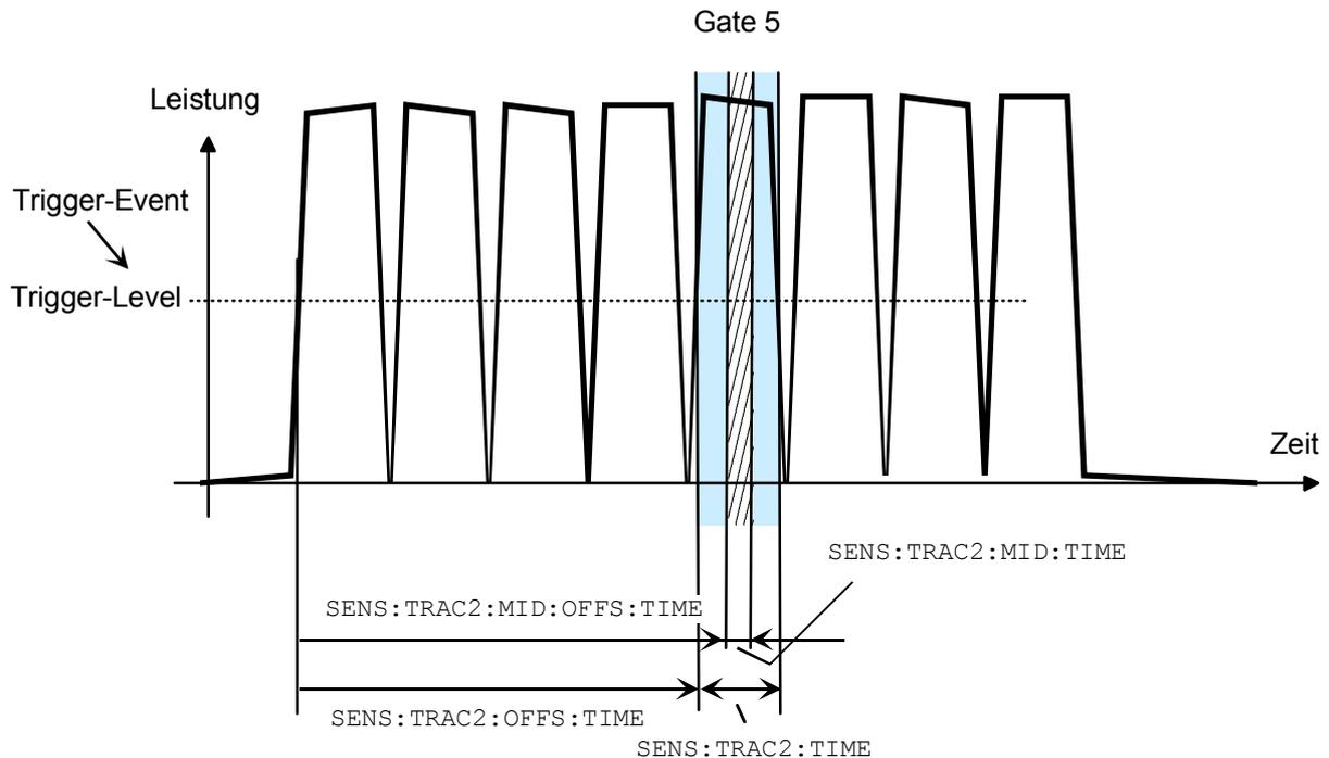
Abbildung I-5: Messung eines GSM-Slots mit Fence(Mid)-Exclude Bereich
