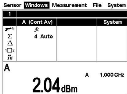
Das Fenster vergrößert sich auf volle Displayhöhe und zeigt alle Parameter, die für die Messung in diesem Fenster relevant sind. Die im Moment angezeigten Werte sind die Defaultwerte nach einem Preset.
