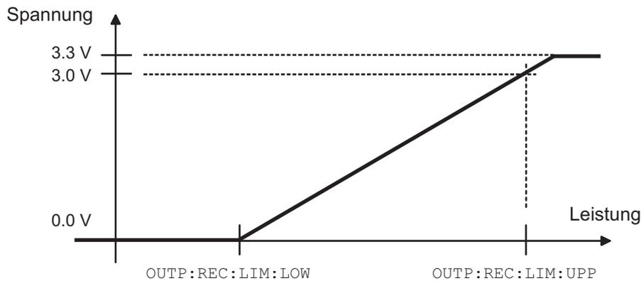
Abbildung 6-5: Kennlinie der Analogausgänge
