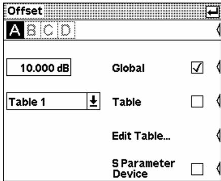
Die globale Offset-Korrektur ist jetzt eingeschaltet. Der Anzeigewert ist dem Offset-Wert entsprechend erhöht oder erniedrigt.
