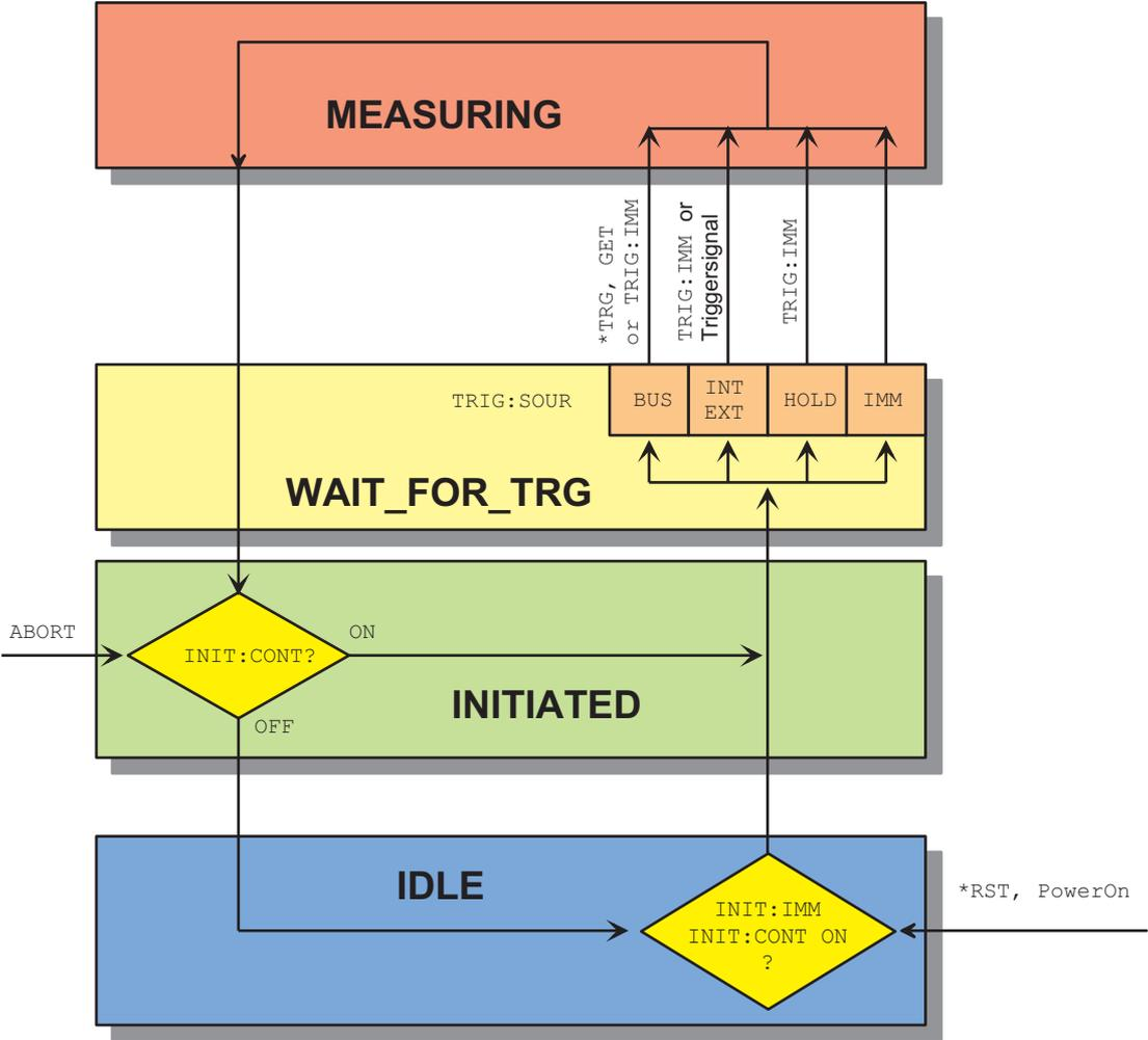
Abbildung I-1: Überblick über die grundlegenden Zusammenhänge im Triggerzustandssystem
