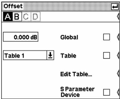
Es öffnet sich der Offset-Dialog. Hier lassen sich Einstellungen von Korrekturfaktoren vornehmen, mit denen sich externe Dämpfungen oder Verstärkungen des Signals korrigieren lassen, wie sie z. B. durch vorgeschaltete Dämpfungsglieder entstehen.
