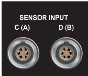
Die Rückwand kann die Messkopfanschlüsse A und B (Option R&S NRP-B6) oder C und D (Option R&S NRP-B5) aufnehmen.
