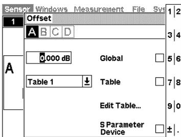
Positive Werte dienen zur Korrektur von Dämpfungen, negative für Verstärkungen.
