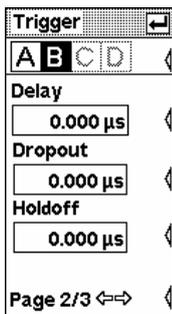
Hier lassen sich mit den Parametern **Delay**, **Dropout** und **Holdoff** Einstellungen vornehmen, die eine sichere Triggerung auch bei komplexen Signalen ermöglichen.
