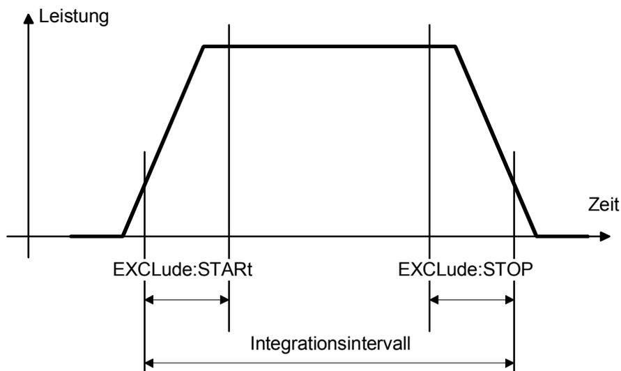
Abbildung 6-11: Wirkung der Befehle SENS[1..4]:TIM:EXCL:STAR und :STOP
