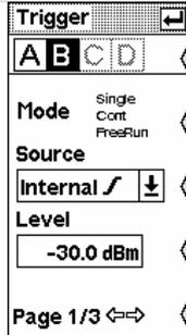
Wenn der Trigger-Dialog in der Trace & Statistics-Darstellung geöffnet wird, markiert eine durchgehende gepunktete Linie im Bild die Triggerschwelle.
