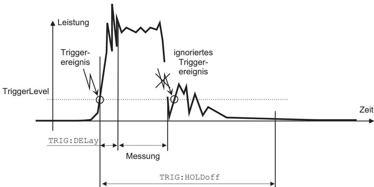
Abbildung I-3: Bedeutung der Einstellungen für `TRIG:HOLD` und `TRIG:DEL`
