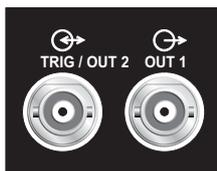
Die BNC-Buchse OUT1 ist ein Ausgang für eine analoge Spannung zwischen 0 V und 3,3 V. Sie kann genutzt werden für die Ausgabe einer messwert-proportionalen Spannung (z. B. für Pegelregelungen) oder eines digitalen Signals für Grenzwertüberwachung.
