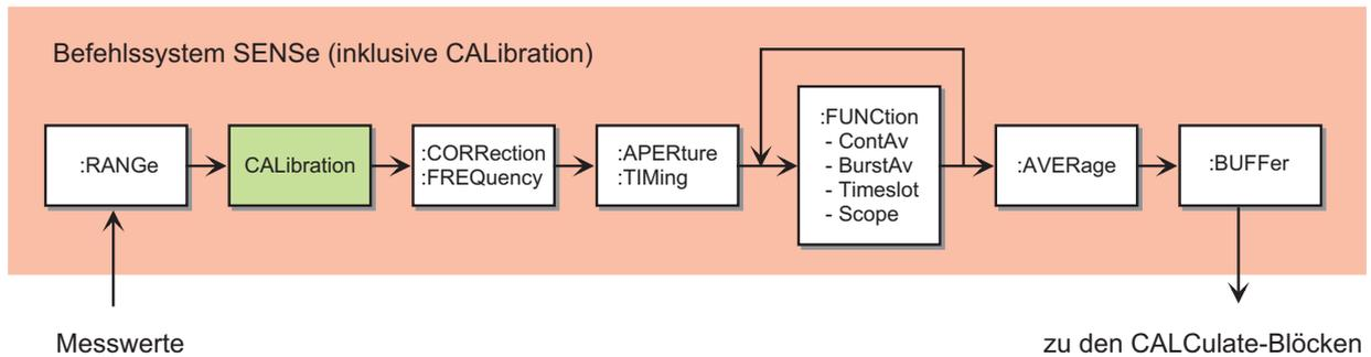
Abbildung 6-2: Das Befehlssystem SENSE
