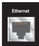
Der Ethernet-Anschluss (Option R&S NRP-B4) ist eine RJ45-Buchse für Fernsteuerung des R&S NRP über ein Netzwerk.
