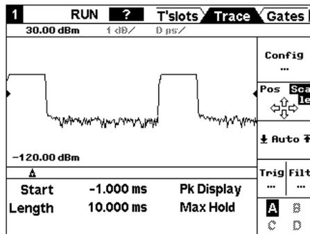
Das Fenster ist jetzt im Trace & Statistics-Darstellungsmodus und zeigt die Seite Trace. Im Untermenü **Config** sind alle für die Darstellung relevanten Parameter aufgeführt. Mit den Feldern **Max** und **Min** kann der darzustellende Pegelbereich (die vertikale Auflösung) gewählt werden, das Feld **Length** gestattet die Wahl der horizontalen Auflösung.
