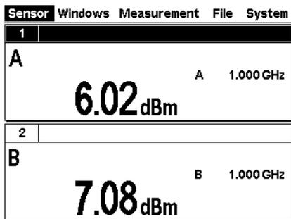
Auf dem Bildschirm sind diesmal zwei Anzeigefenster mit den Messergebnissen der Messköpfe A und B (in dBm) sichtbar.
