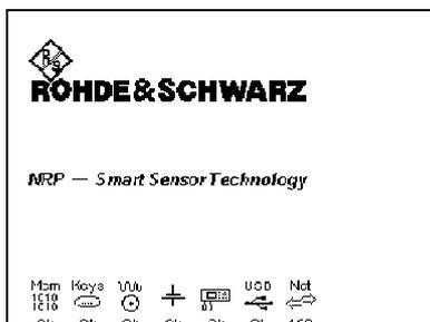
Nach dem Einschalten führt das R&S NRP einen Selbsttest durch. Es werden dabei die Funktion des Schreib-/Lese-Speichers (RAM) und die Ansprechbarkeit aller Schnittstellen überprüft. Außerdem erscheinen Meldungen über die installierten Optionen.
